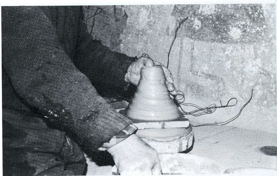
Fig. 13 — O oleiro penetra a péla com os dedos polegares, cavando nela um espaço interior
