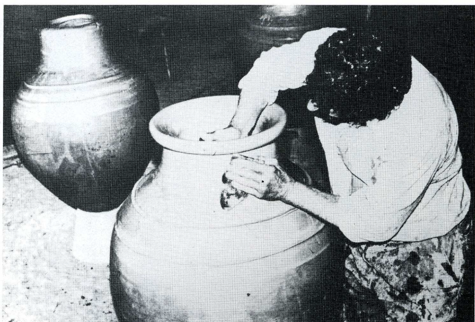
Fig. 24 — O oleiro alisa o barro da boca da peça e dá-lhe os últimos retoques
