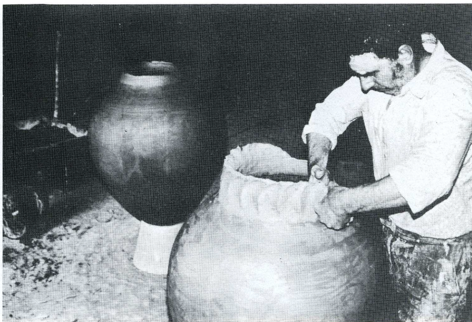
Fig. 22 — Dando barro para a construção da boca da talha , pela técnica dos rolos-em-anéis
