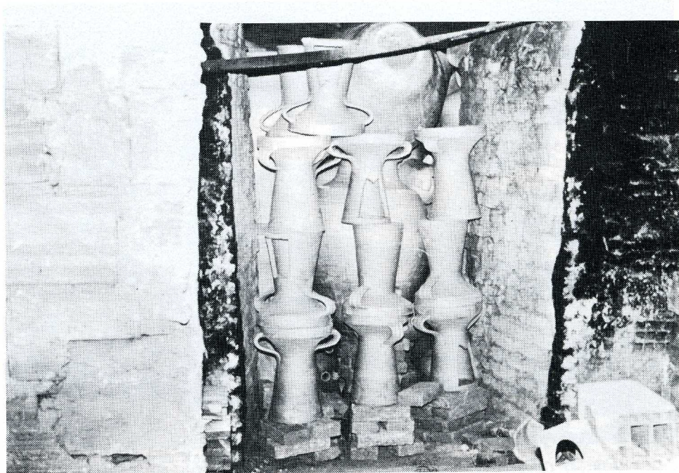
Fig. 27 — Louça de barro enfundada na caldeira , para ser cozida
