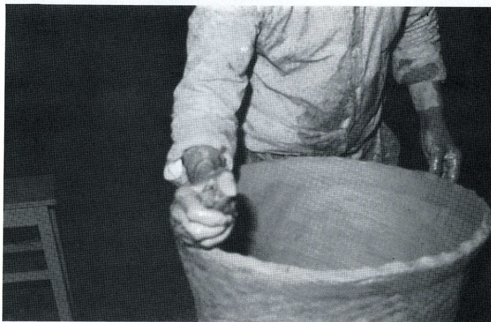
Fig. 20 — O artesão molha o barro , isto é, humedece a superfície da peça em modelação, para a argila ficar mais plástica
