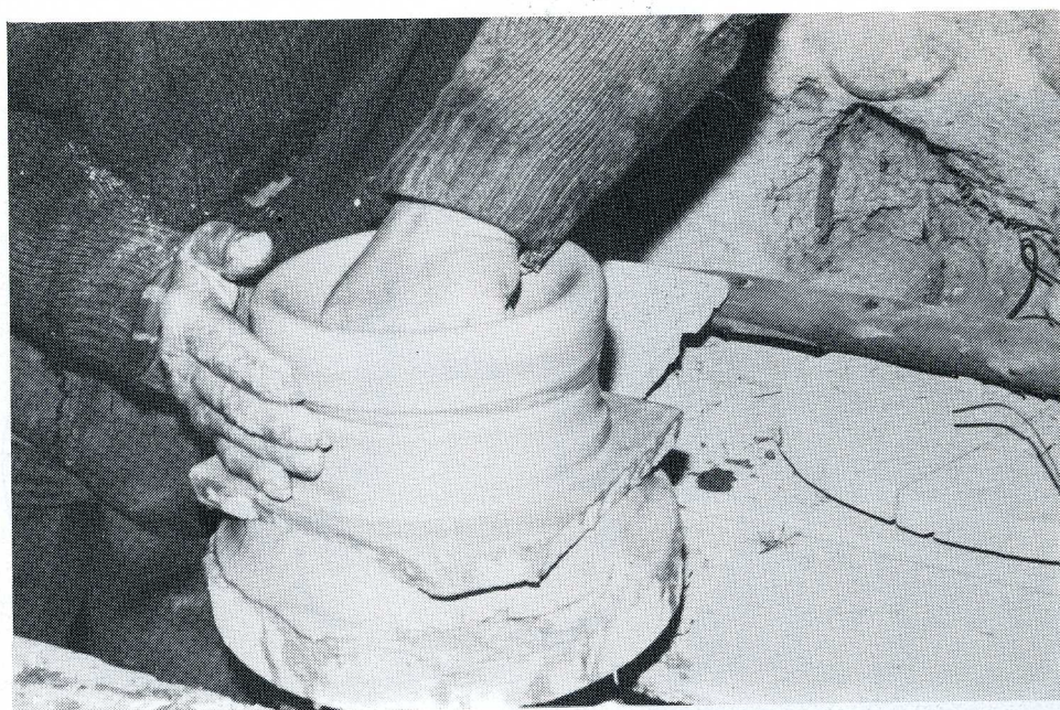
Fig. 14 — O artesão puxa o barro , isto é, trabalha a pasta de argila de modo a diminuir-lhe a espessura em favor do aumento em altura e/ou do diâmetro, sem que ela abra
