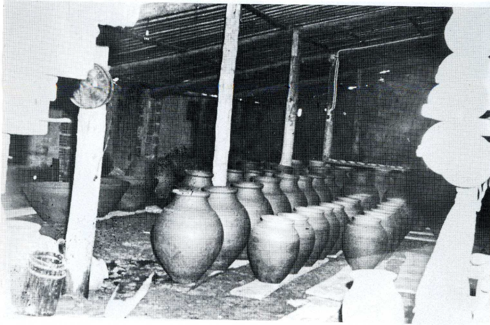
Fig. 25 — Enxugo do barro. Sala para enxugo.
