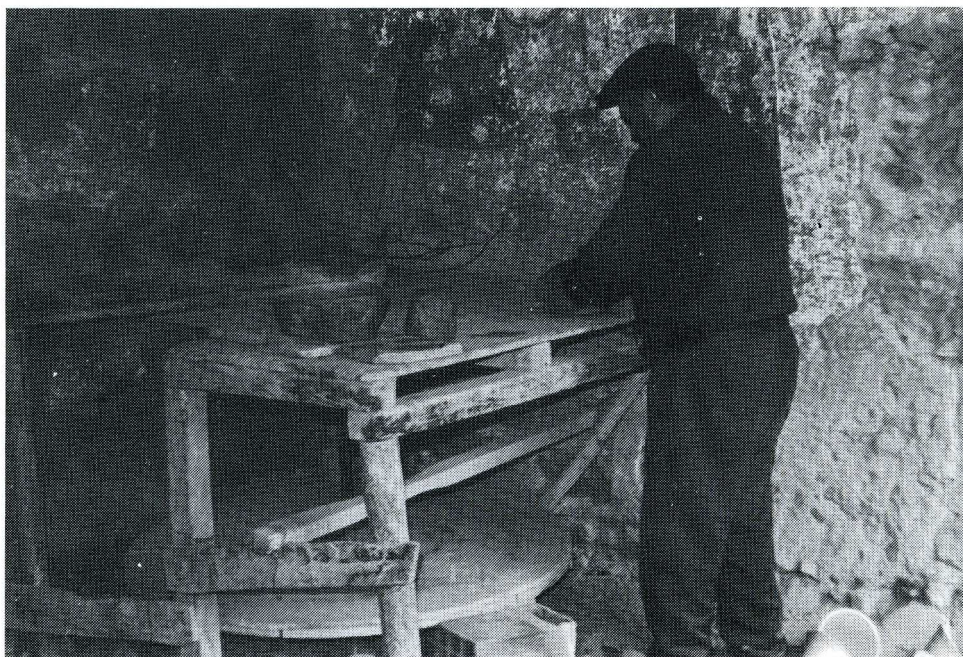
Fig. 11 — Formação da pêla ou bola , sobre a arquina ou adoquina da roda-de-oleiro
