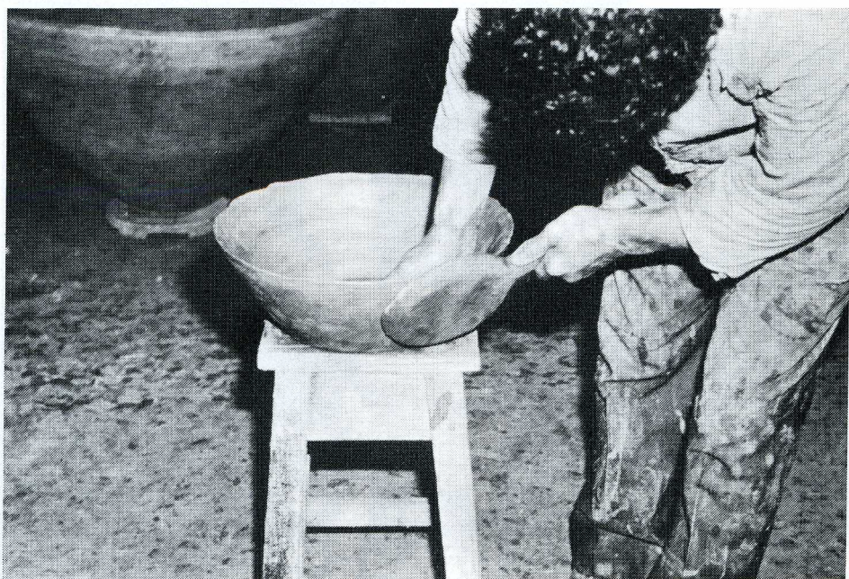
Fig. 18 — O artesão palmatoa o barro , em toda a superfície exterior da peça, utilizando para isso uma palmatória
